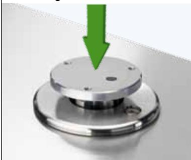
La cellule de pesage est équipée d'une protection mécanique contre les surcharges statiques verticales comprises entre 25 et 50 fois la capacité de pesage. Ce système protège le module de pesage en cas de dysfonctionnement des dispositifs de manipulation ou d'erreurs d'installation.
