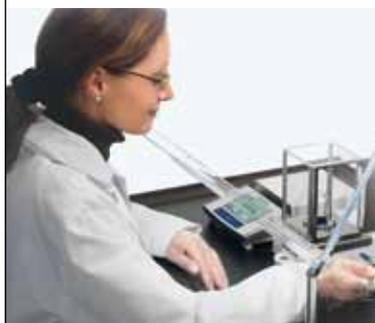
Les modules de pesage WXT à faible encombrement et équipés d'un revêtement poudre conviennent aux procédés de pesage manuels partout où l'espace est une condition critique. L'accessibilité à 360° garantit une souplesse maximale tant pour l'implantation que pour l'opération à réaliser.
