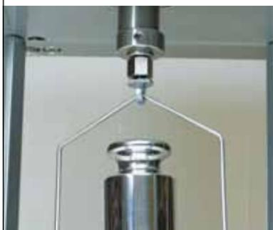
Un adaptateur optionnel permet de peser des charges suspendues sous le module. La protection de surcharge demeure assurée dans toutes les directions.
