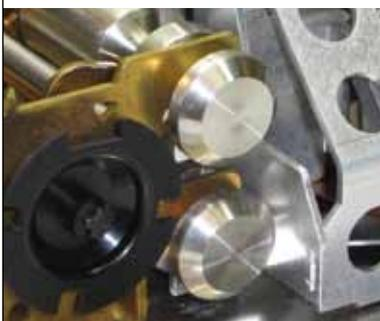
La fonctionnalité, la linéarité et la précision peuvent être contrôlées à tout moment à l'aide des deux poids d'étalonnage intégrés. Les adaptateurs spécifiques placés au-dessus du plateau de pesage n'ont pas besoin d'être retirés pour l'étalonnage s'ils représentent moins de 25% de la charge maximale.
